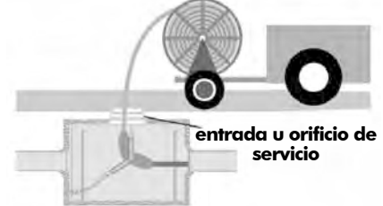
desenrollo de cables desde la parte superior
