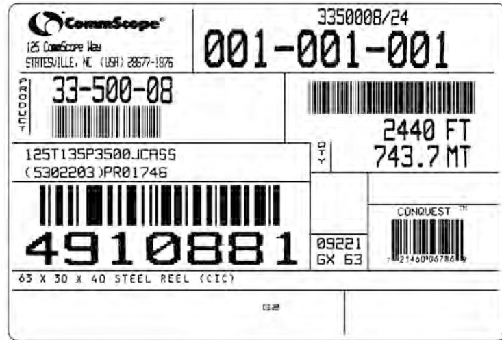
Etiqueta típica de carrete para CIC con producto P3 500 JCASS.
